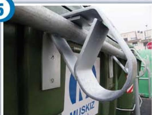
5. El sistema queda con las grapas enganchadas y cerradas, anclando el contenedor.
