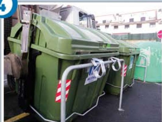
4. El camión baja el contenedor que se coloca exactamente en la misma posición. Las grapas se enganchan automáticamente.
