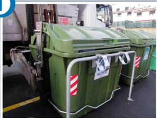
1. El sistema automático del camión engancha el contenedor.
